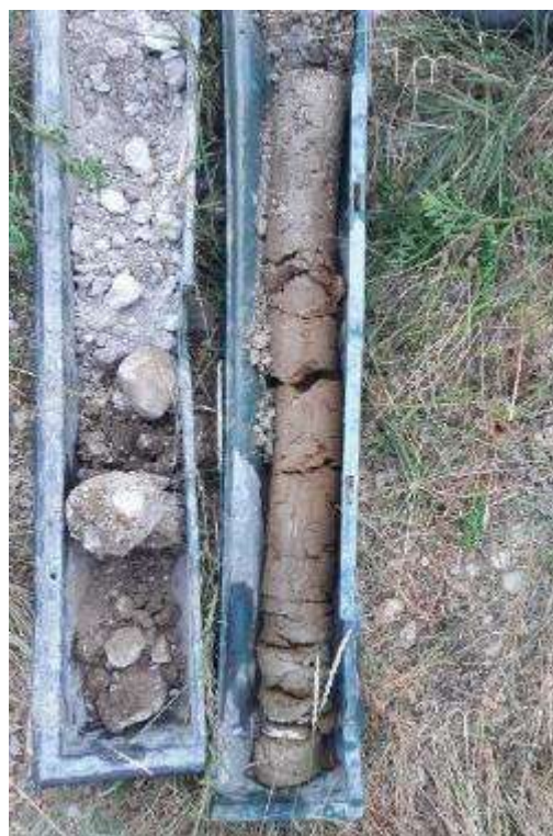
Figure 27 : Lithologie sondage S1
