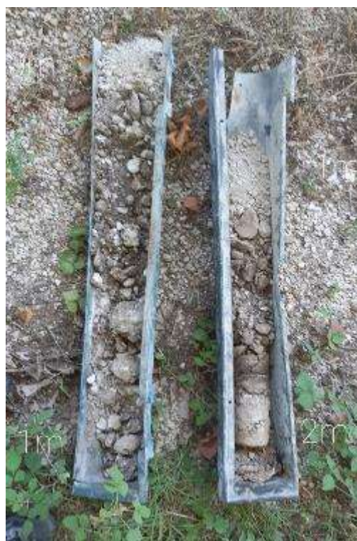
Figure 33 : Lithologie sondage S4
